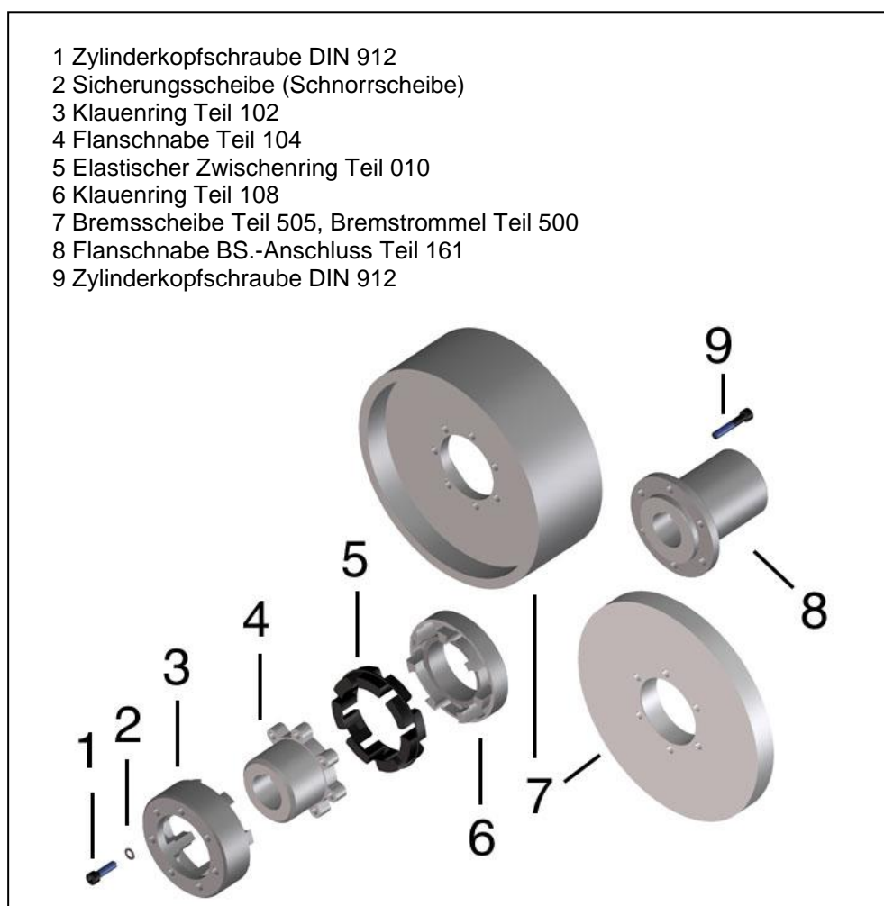
Bild 1 Aufbau RINGFEDER® TNM GHBS
